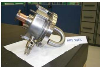
Figure 2 : Dipolar HOM coupler.
